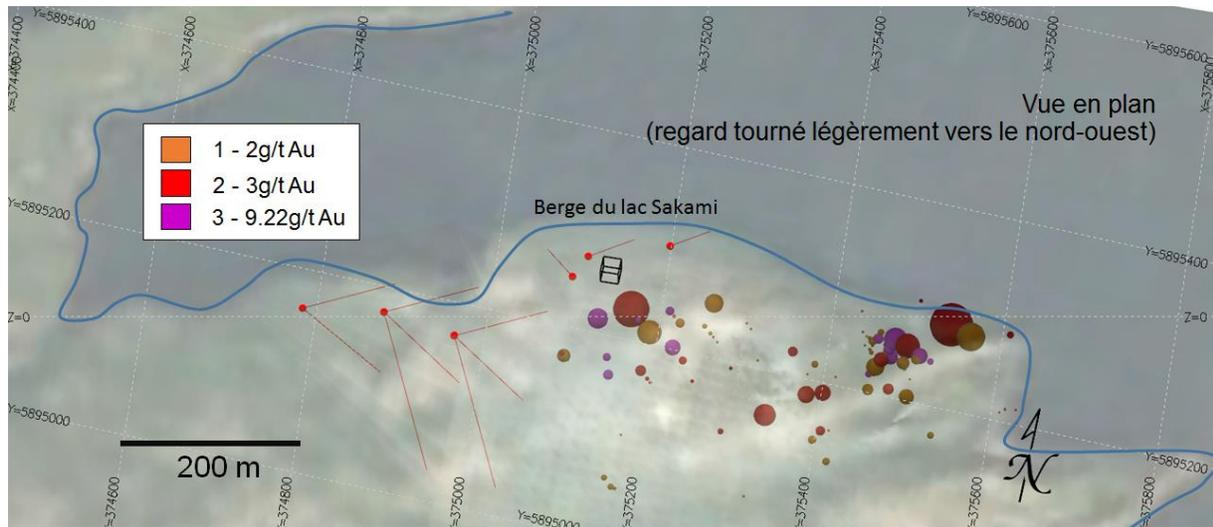
Figure 1. Image oblique de la Zone 25 montrant la répartition des intervalles minéralisés créés en utilisant une limite inférieure à 1 g/t et représentés sous forme de sphères selon l'épaisseur. Les traces rouges représentent le forage planifié.
