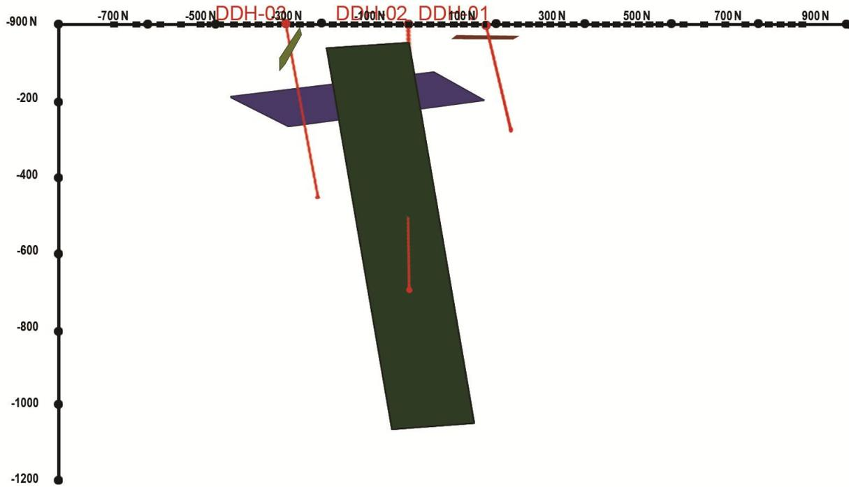
Vue en section (regard vers l'est) on constate la continuité en profondeur du conducteur EM-03 en vert, dépassant les 800 mètres.
