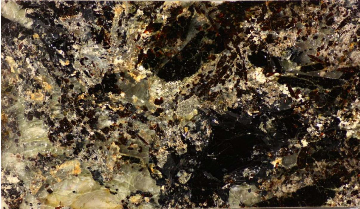
**Fig. 2 T-780B<sub>1</sub> en lumière naturelle** Ces sections polies sont riches en fergusonite et allanite (en noir). Elles contiennent de plus un oxyde d'Y, Nb, Ti adjacent et en auréole autour de la fergusonite. Son identification exacte est encore à l'étude, mais la courbe d'élément du microscope électronique semble favoriser le minéral euxenite (Y) – (Y,Ca,Ce,U,Th) (Nb,Ta,Ti)<sub>2</sub>O<sub>6</sub>. Dimensions de la section polie = 4.5 X 2.5 cm.
